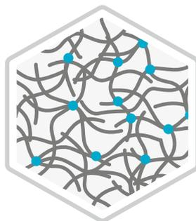
Die Fasern werden durch Thermobonding miteinander verbunden.
