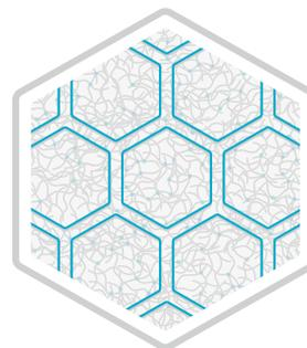
Der Verband wird zusätzlich mit einem Hexagon-Netz durch Ultraschall-Prägung verstärkt.
